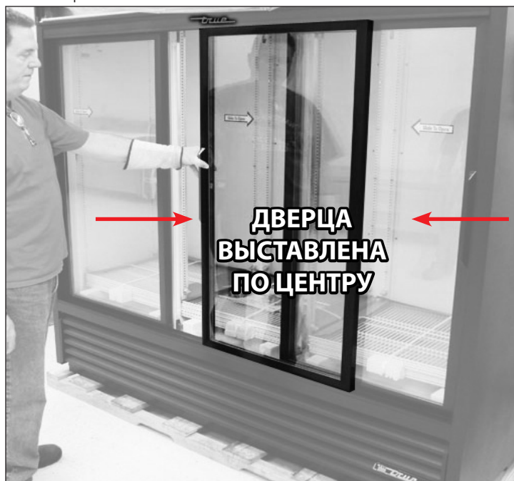
Рис. 3. Модели с тремя дверцами. Расположить среднюю дверцу таким образом, чтобы ее центр приходился на левый край правой дверцы.
