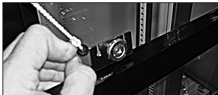
Рис. 8. Выдвинуть черный пластмассовый наконечник тросика из задней части.
