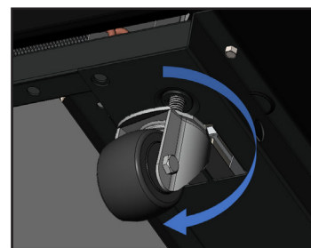
Рис. 8. Расположить прокладки под углом 90° относительно друг друга.
