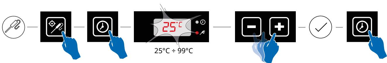
Es posible presionar de nuevo el botón 14 para volver a la modalidad de cocción temporizada y presionarlo de nuevo para volver a la modalidad de cocción con sonda corazón. Pero con cada cambio de tipo de cocción vuelven a los valores preestablecidos los parámetros de duración y temperatura de la sonda corazón.
