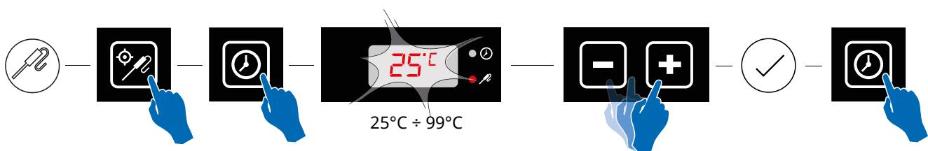
Durch erneutes Drücken der Taste 14 können Sie in den zeitgesteuerten Garmodus zurückkehren und durch erneutes Drücken in den Garmodus mit Kerntemperaturfühler. Allerdings werden bei jeder Änderung der Garmethode die Parameter Garzeit und Kernfühlertemperatur auf ihre Standardwerte zurückgesetzt.
