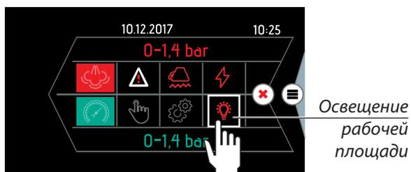
Для включения или выключения освещения боковых сторон корпуса машины нажмите кнопку
