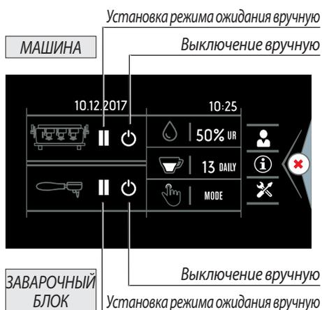
Если машина находится в выключенном состоянии либо в состоянии энергосбережения "Energy Saving", для того чтобы возобновить работу, необходимо нажать на дисплей. Машина вернется в рабочее состояние в течение одной минуты.
